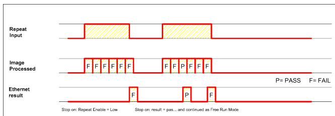
Fig. 264: Input, Repeat Mode Enable, in Freerun
