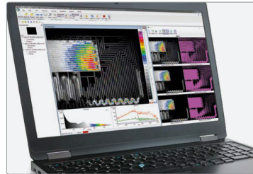
열화상 소프트웨어 IRBIS® 3 활성으로 전자 기기의 위상잠금 열화상 기록
