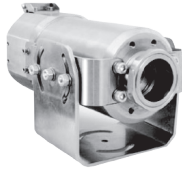
TM-JAB-CTL 조절 가능 마운팅 브라켓에 설치한 TM-J-CTL 쿨링 재킷 길이 228 mm, ø89 mm 주위 온도 최대 315°C
