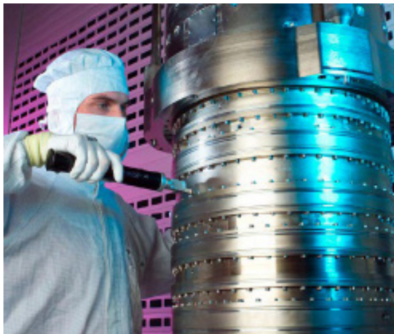
웨이퍼 노출에 사용되는 광학 시스템 렌즈의 나노미터 단위의 정밀성을 위한 정전용량 변위센서의 사용
