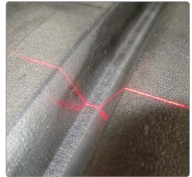
파이프의 V자 갭 측정
