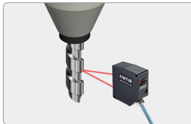
대구경 드릴의 처짐 측정
