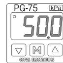
(윈도우 콤퍼레이터 모드 설정할 경우) (M) 버튼을 누르면 디스플레이 색이 바뀌고 동시에 SW1 LED가 깜빡이면서 P3의 현재 값이 표시됩니다. P3의 값을 같은 방법으로 설정 하십시오. 단, P3과 P4 설정 범위는 히스테리시스의 영향을 받습니다. 자세한 내용은 동작 스위칭 모드 표를 참고하십시오.
