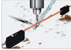
NC 기계의 드릴 파손
