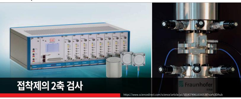
다른 무엇보다도 고강도 및 고강성 구조용 접착제의 전단 및 인장 강도를 파악하 기 위해서는 이중 샘플 튜브를 사용해야 합니다. 이 경우, 두께가 얇은 두개의 튜브 를 연결할 부품을 테스트할 접착제의 앞쪽에 연결합니다. 이들 튜브는 유압 장력 기기를 이용하여 테스트 장비의 하중 경로에 고정됩니다. 접착 본드의 두께는 보통 몇 십 분의 일 밀리미터에 불과합니다. 이제 샘플을 장력 (축 변위) 및 / 또는 비틀림 을 통해 로딩합니다. 이후 샘플은 장력 (축 변위) 혹은 비틀림 현상에 의해 위치가 변하게 되는 데 이로 인해 도출되는 튜브 연결 부품의 상대적 변위값은 가해진 힘 과 비틀림 동작에 따른 결과로 인식됩니다. 이러한 물리적 부하로 인해 접착제의 결합이 끊어질 때까지 몇 마이크로미터에 불과한 변위가 발생합니다. 그리고 접착 제의 강성을 파악하기 위해 측정된 변위값은 서브마이크로미터 단위를 지닙니다.
