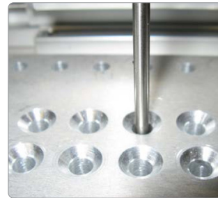
IFS2402/90 센서를 사용한 작은 타공의 직경 측정
